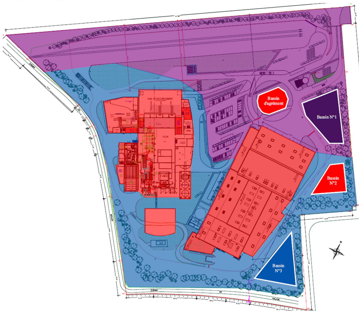
Figure 50 : Gestion des eaux pluviales par bassin versant
